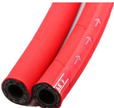
Напорный рукав с металлокордом для насыщенного пара под давлением до 18 бар, используется в химической, нефтехимической, пищевой и др. отраслях промышленности. Может применяться для перегретого пара при пиках до +230°C и 18 бар. Внимание: подача перегретого пара сокращает срок службы рукава. Для увеличения срока службы рекомендуем обеспечивать отток остаточной воды после каждого применения.
